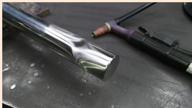
ペーパーに付け替えて仕上げ削りを施します。
