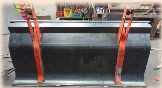
腐食が酷いトラクター用ロータリーカバーの原寸を採寸後、曲げ加工にて一から再現し、使える部品は再利用します。曲げ・溶接・溶断を駆使し製作することになります。
